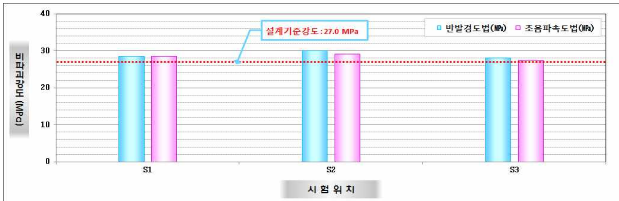
【그림 3.3.10】 상부구조(바닥판하면) 평균압축강도 추정결과
